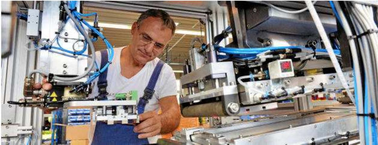
Komplexe Fertigungstechnik wird hier integriert. Mechaniker Harald Born legt bei Automation Uhr Hand an, damit die Anlage zum blasenfreien Aufbringen einer Spezialfolie auf Oled-Module verschiedener Größe ausgeliefert werden kann. Foto: Peter Michaelis
